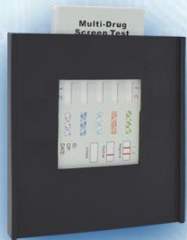
Переходник с магнитным креплением для проведения анализа тест-кассет
