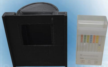
Переходник с магнитным креплением для проведения анализа тестов по слюне
