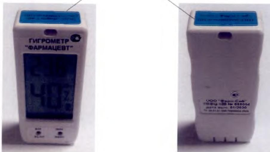
Рисунок 2 – Общий вид гигрометра «Фармацевт» модели ТМФЦ-100
