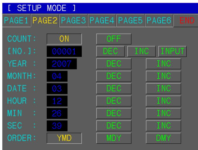
Для смены страницы нажмите одну из шести кнопок, обозначенных в верхней части экрана.
