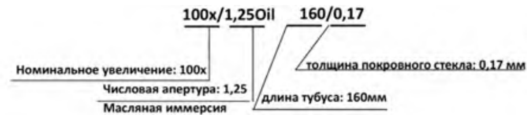
Рисунок 2. Маркировка объектива
