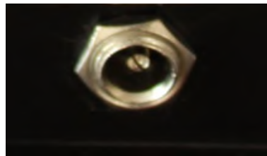
Рисунок 7. Разъем для подключения шнура сетевого
