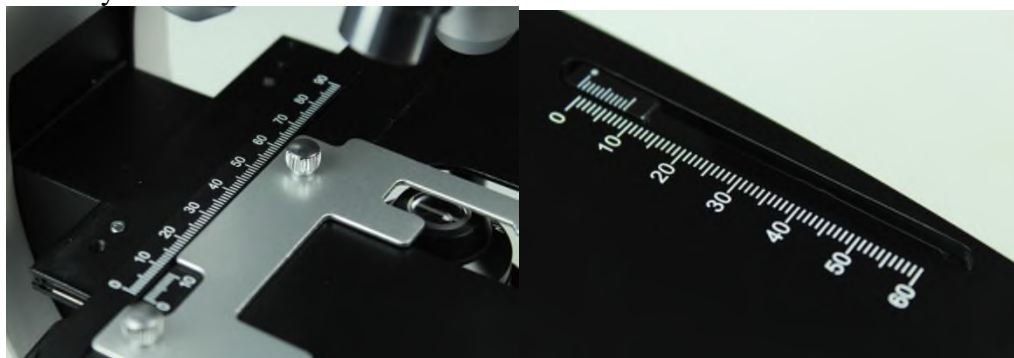
Рисунок 5. Шкала на предметном столике
