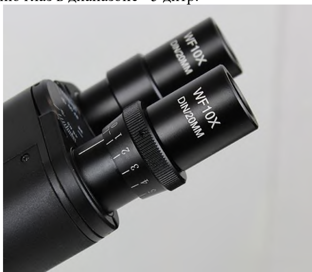
Рисунок 8. Кольцо диоптрийной наводки
