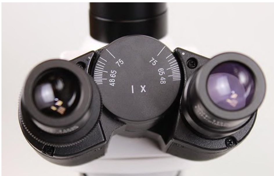
Рисунок 7. Шкала межзрачкового расстояния
