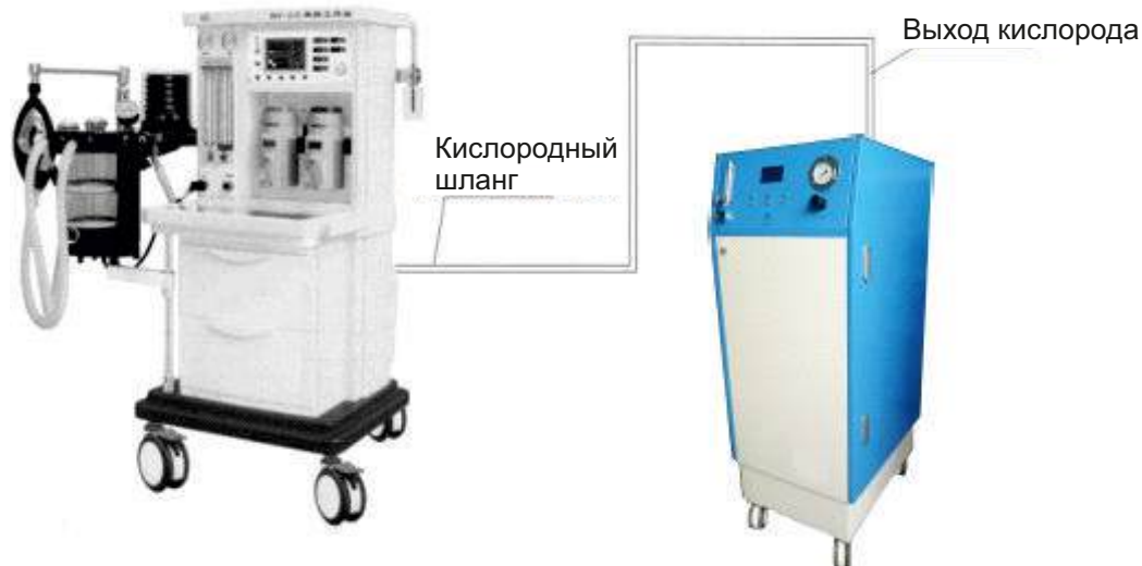
Рис. 22 – Схема подключения концентратора кислорода «Armed» к наркозному аппарату или аппарату ИВЛ
